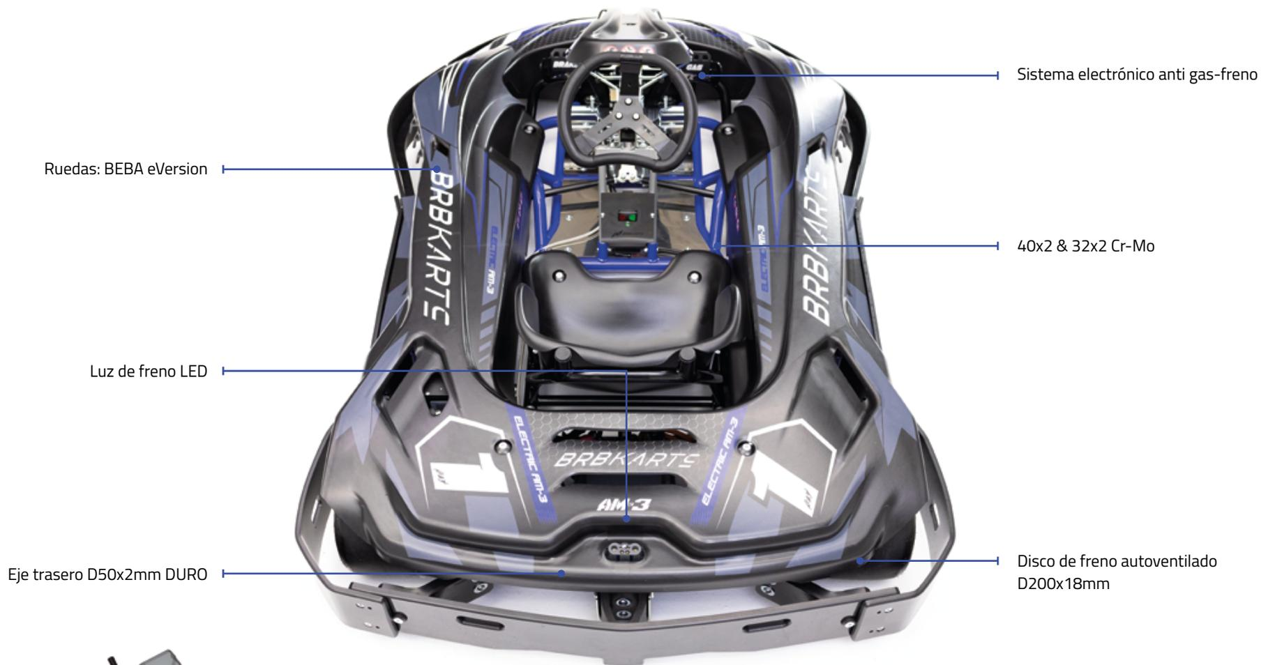
Sistema electrónico anti gas-freno
